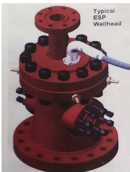
شکل ۲-۱۱ تجهیزات سرچاهی مورد استفاده در پمپ های شناور
