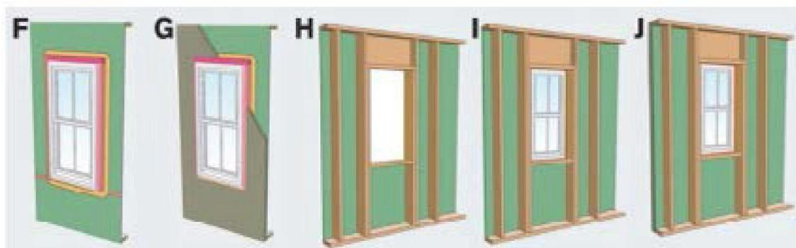
شکل ۷. ترتیب عایق پیوسته برای عایق فیبر معدنی (پشم سنگ). توجه داشته باشید درز گیر مایع بکار برده شده برای تأمین پیوستگی با لایه کنترلی آب روی سطح پوشش سازه و قاب منظره و سازه الحاقی است. درز گیر مایع بکار برده شده داخل بازشوی قاب پنهان می شود و «درز گیر پیوسته» برای بازشو بوجود می آورد. نصب پنجره همانند انواع داخلی است
