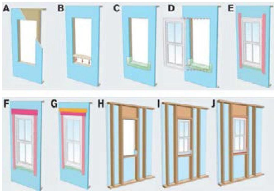
شکل ۶. ترتیب عایق پنجره برای خارجی ها. لایه کنترل هوا و آب طرف عایق پیوسته است. توجه کنید که کنترل آب پنجره لبه دار با کنترل آب طرف عایق پیوسته هم تراز می شود. دوباره به آستانه لبریز شدن و اینکه درزگیر می تواند مایع و یا لایه انعطاف پذیر باشد توجه کنید. همچنین توجه داشته باشید نیازی به درزگیر پشت لبه پنجره نیست. نهایتاً هیچ چوبی پشت لبه پنجره وجود ندارد و لازم نیست لبه مستقیم روی عایق پیوسته قرار بگیرد؛ شما پنجره را از طریق لبه و عایق پیوسته به وسیله پیچ های بلند به چارچوب متصل می کنید
