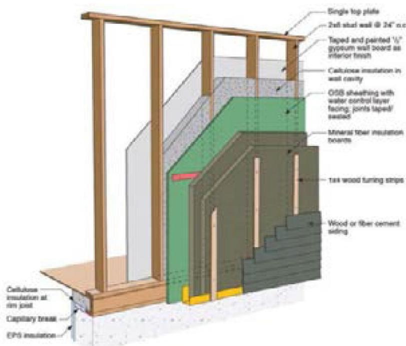
شکل ۴: عایق فیبر معدنی (پشم سنگ). با عایق فیبر معدنی، طرف عایق نمی تواند لایه کنترل هوا و آب باشد. همچنین ما نیاز به پوشش سازه با عایق فیبر معدنی داریم. معمولاً پوشش سازه به لایه کنترل آب و هوا تبدیل می شود
