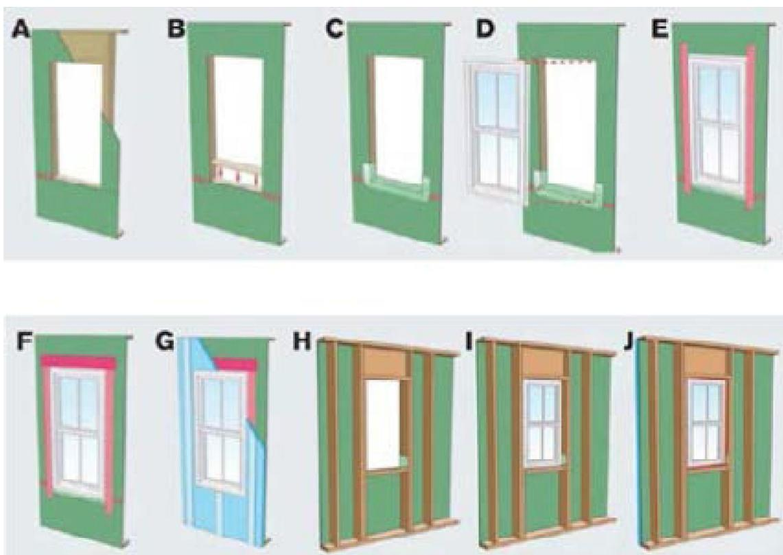
شکل ۳. ترتیب عایق پنجره برای تو کارها. لایه کنترل هوا و آب پوشش پشت عایق پیوسته است. توجه کنید که کنترل آب پنجره لبه دار با کنترل آب پوشش هم تراز است. به درگاه شیب دار توجه کنید. توجه داشته باشید که درزگیر می تواند مایع یا غشای قابل شکل دهی باشد. توجه کنید درزگیر پشت لبه ها لازم نیست. درزها در عایق پیوسته نیازی به درزگیر یا نواریچی ندارند
