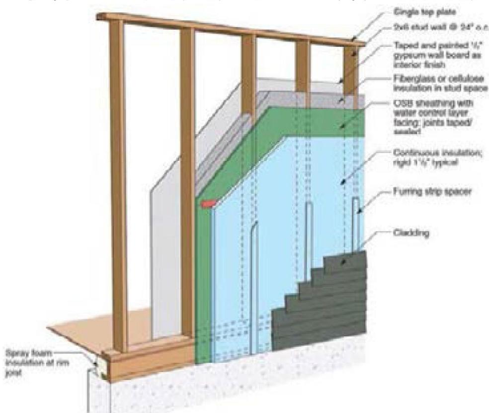
شکل ۱: پوشش سازه به عنوان لایه کنترل هوا و آب. عایق پیوسته روی پوشش سازه نصب می شود
