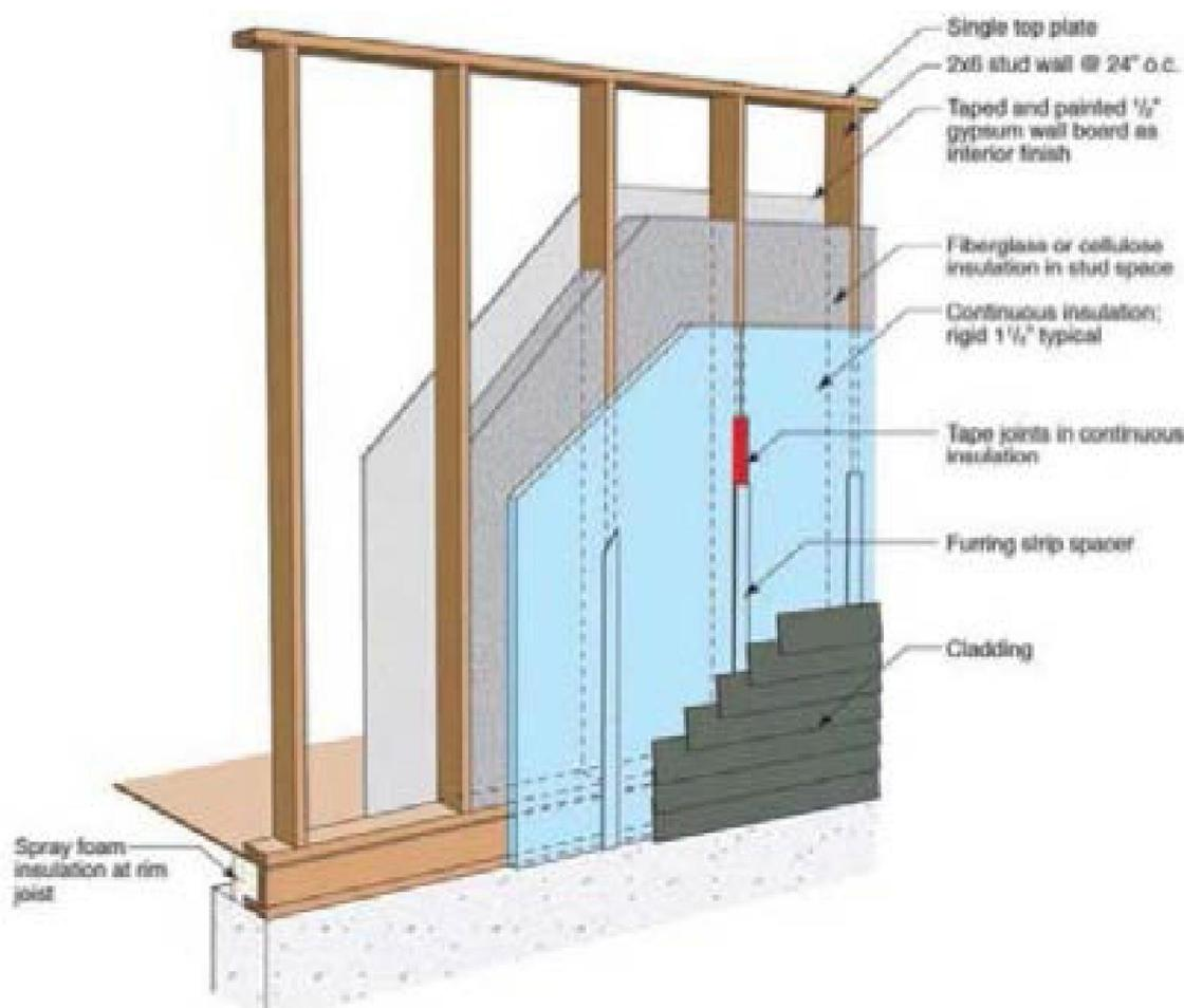
شکل ۲: عایق پیوسته به عنوان لایه کنترل هوا و آب بر اساس ملاحظات سازه شامل پوشش سازه می شود یا آنرا در بر نمی گیرد
