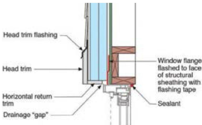
شکل ۵. سر پنجره - لبه در بالای پنجره - به طرف پوشش سازه/لایه کنترل هوا و آب پشت عایق پیوسته وصل می شود. یک شکاف در طرف داخلی تزئینات برگشت افقی در بالای بازشوی پنجره گذاشته می شود تا اجازه جاری شدن آب باران بین لبه پنجره و تزئینات افقی را بدهد
