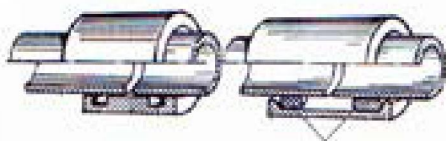
نمونه‌ای از اتصال لوله‌های سیمان آریستی
